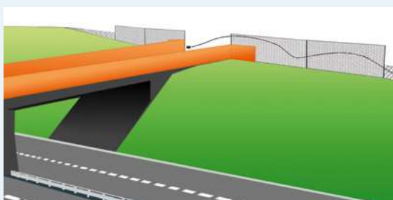
Illustration 83 : Principe de guidage aux abords d'un passage supérieur (Source : Cerema - Est)
